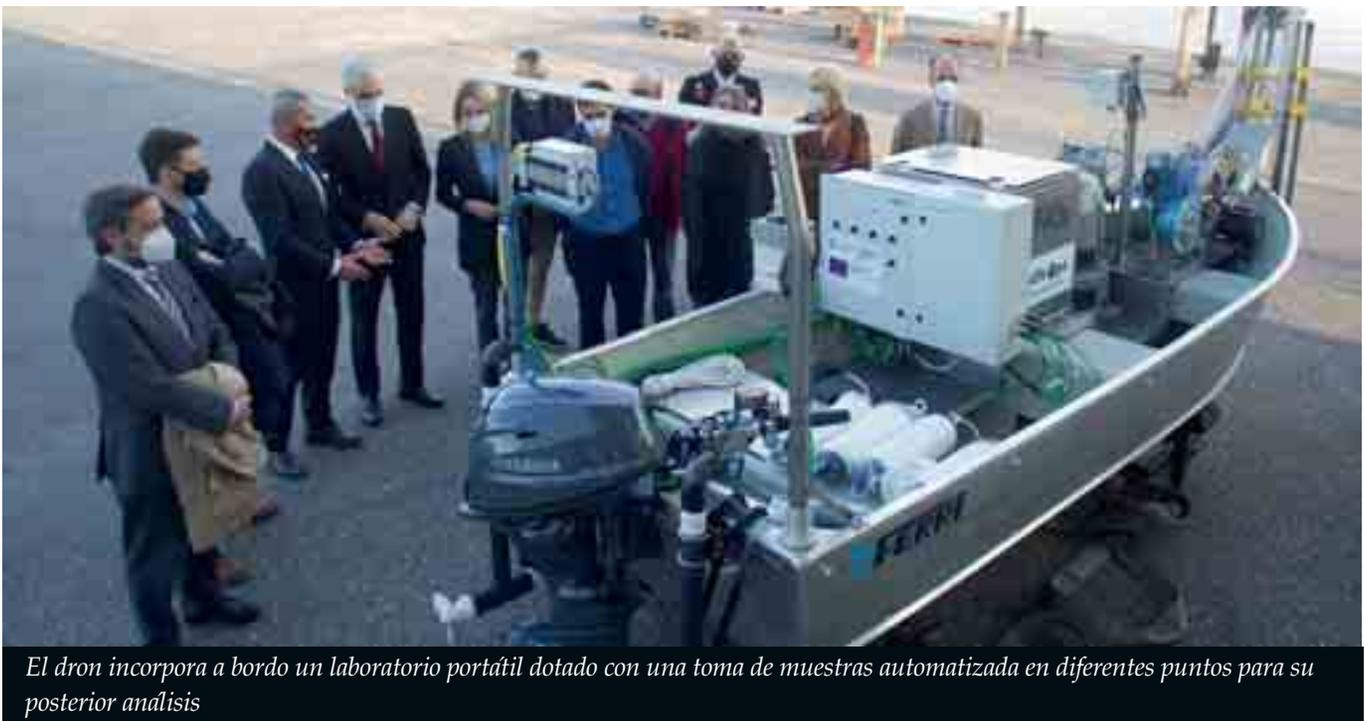
El dron incorpora a bordo un laboratorio portátil dotado con una toma de muestras automatizada en diferentes puntos para su posterior análisis
